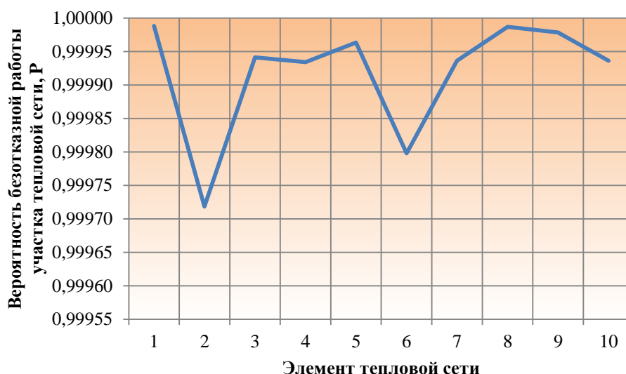
Рисунок 8.5 - Вероятность безотказной работы участков тепловой сети
